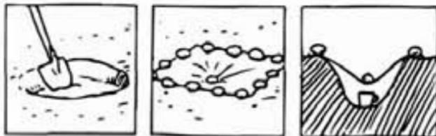
El agua evaporada del suelo queda atrapada y se condensa en la cara inferior del plástico, y escurre a la taza. (Por la noche, la condensación del aire se acumula en la cara superior del plástico.)
