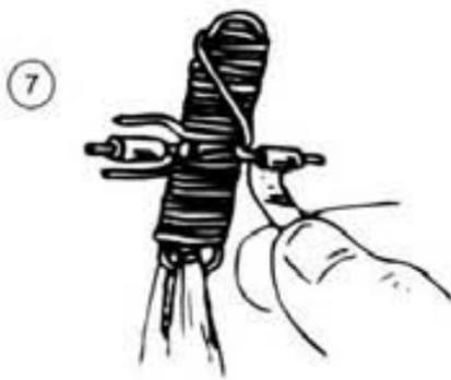
**Paso 7.** El siguiente paso es cortar los extremos del alambre para que sean un poco más cortos que el extremo saliente del broche. A continuación pela el recubrimiento de los extremos, asegurándote de dejar expuesto el cobre desnudo.
